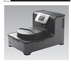
遊星型のパイオニアであるドイツフリッチュ 社が、時代が要求するNANO領域の粉末を 作成する目的で新たにご紹介する遊星型 ボールミルです。従来の弊社製品と比べても 2.5倍のパワーを有しており、94Gのパワーが 皆様をNANOの世界にご案内いたします。加 えて容器は本体に内蔵されておりますので皆 様方の安全な作業に十分配慮してございま す。容器の多様性も大きな特色かと思いま す。加えて卓上タイプであることは研究室の スペースの問題を解消します。
